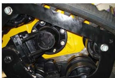
3. Se alinea el piñón impulsor de la VTS
