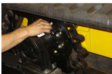
3. Se alinea el piñón impulsor de la VTS
